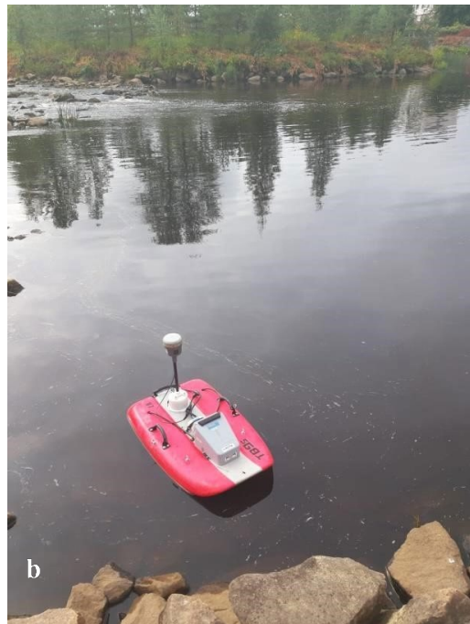
Kuva 4. Diplomityöntekijä Louis Addo tekemässä mittausta RTK/GPS-mittalaitteella matalilta, koskimaisilta alueilta (a) sekä syviltä alueilta mittauksiin käytetty kauko-ohjattava pienoisvene, jossa oli SontekM9 -mittalaite (b).
