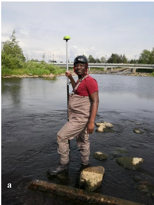
Kuva 4. Diplomityöntekijä Louis Addo tekemässä mittausta RTK/GPS-mittalaitteella matalilta, koskimaisilta alueilta (a) sekä syviltä alueilta mittauksiin käytetty kauko-ohjattava pienoisvene, jossa oli SontekM9 -mittalaite (b).
